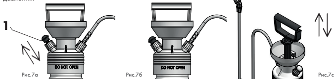
Рис.7а Предохранительный клапан открыт
